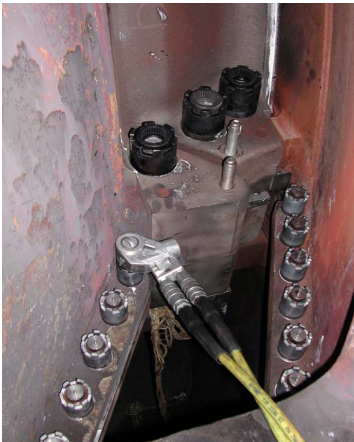
SmartSTUD ersetzt Inbusschrauben im Kraftwerksbereich
