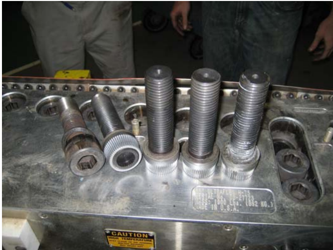
SmartSTUD ersetzt Inbusschrauben
